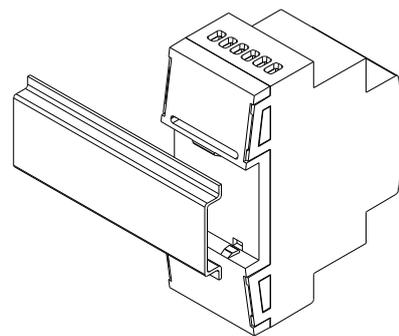
Figure 3. Montage du dispositif sur rail DIN
