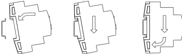
Détacher le dispositif du rail DIN:
